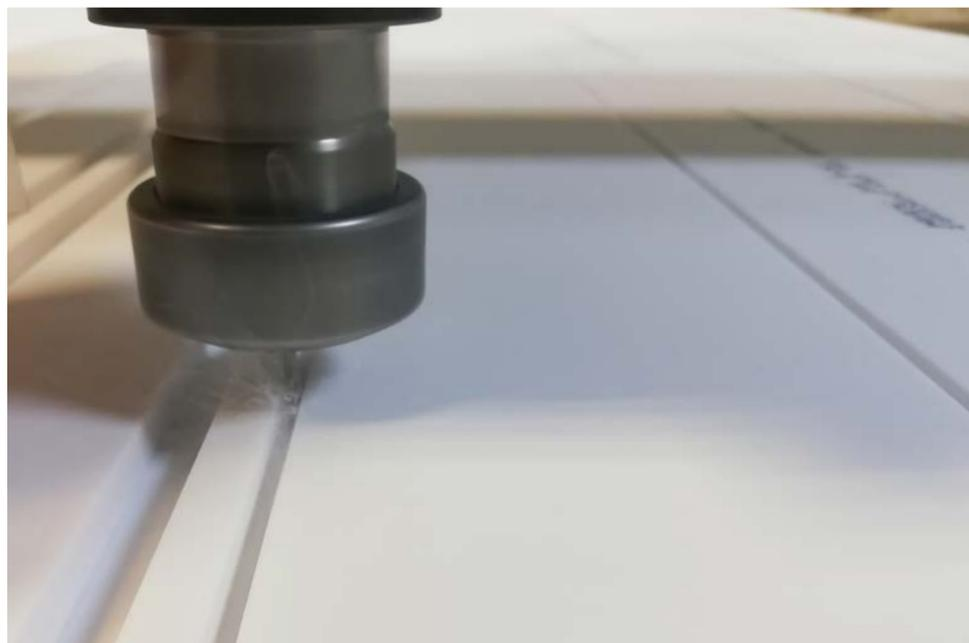
Декарх производится на ЧПУ станке, по предварительно загруженной в него 3D модели.
